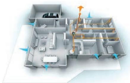
Su funcionamiento está basado en el principio de barrido del aire dentro de las viviendas desde las habitaciones secas (dormitorios y salón) hasta los cuartos húmedos (cocina y baños). Debido a que el sistema dispone de rejillas, el caudal de ventilación se adapta de manera automática a las necesidades de los ocupantes de cada estancia, en función de la tasa de humedad, aportando un mayor nivel de confort y ahorro energético a los sistemas de climatización.
